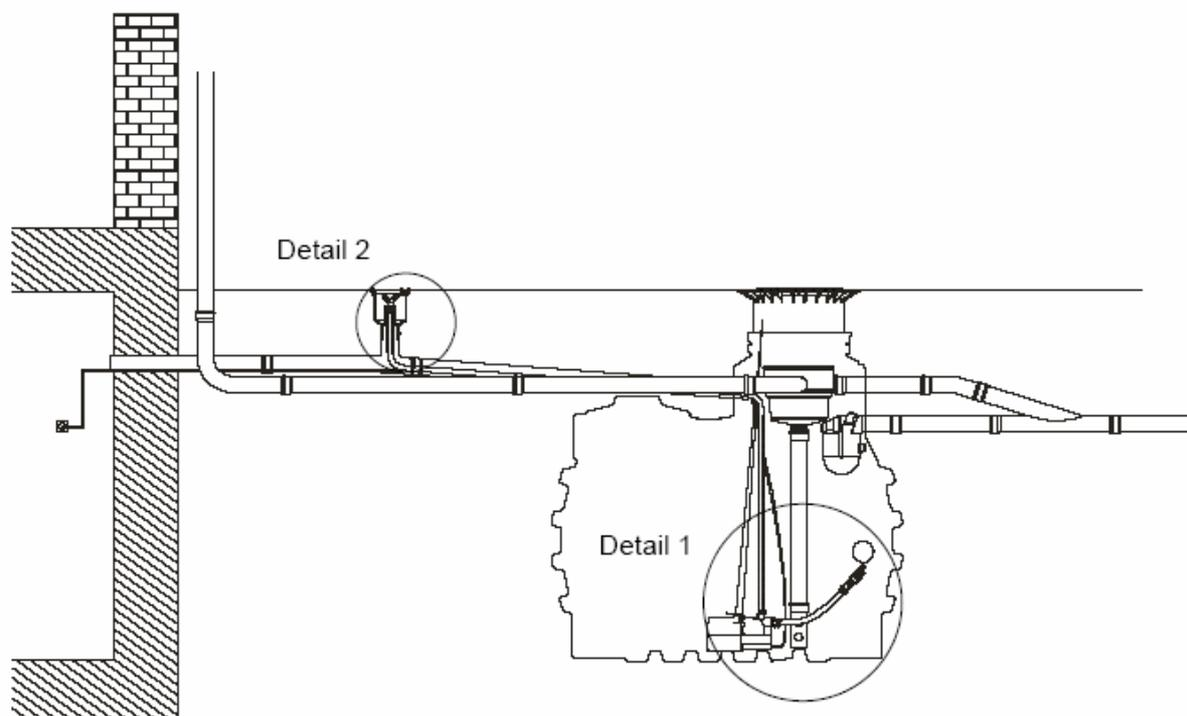
**Attenzione:** la distanza tra il box di collegamento e il serbatoio è limitata dalla lunghezza del tubo in pressione ed è di 10 m!
